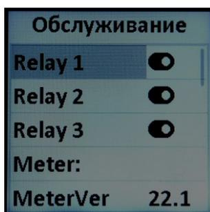
Пункты Relay 1, 2 и 3 предназначены для проверки прохождения сигналов релейных выходов прибора от контактов разъема до контрольного оборудования. Выберите пункт соответствующий тестируемому реле и нажмите на клавишу «ОК» для переключения.
